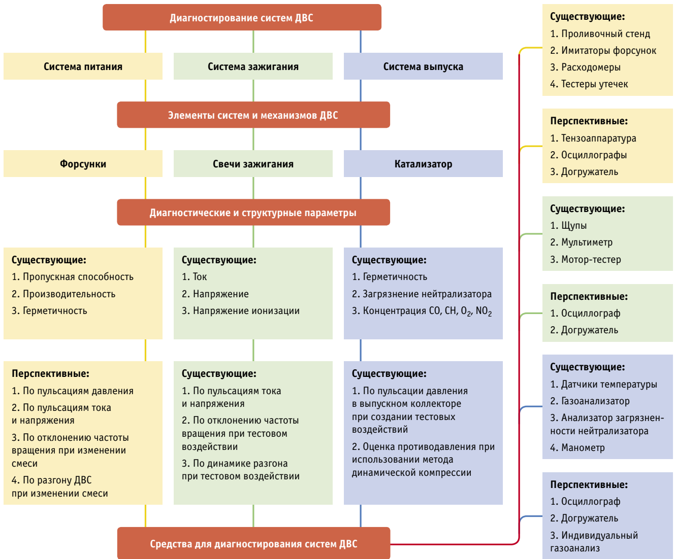
Рис. 1. Элементы систем двигателя и применяемые параметры диагностирования
