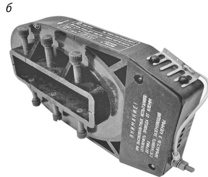
Рис. 3. Датчики для измерения постоянного или переменного тока (ДТ-10к-4к): а, б — первый и второй варианты исполнения датчика тока соответственно
