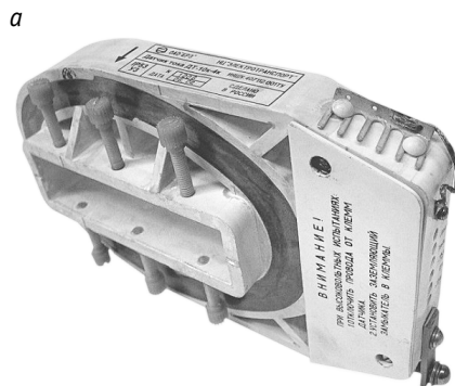
Рис. 3. Датчики для измерения постоянного или переменного тока (ДТ-10к-4к): а, б — первый и второй варианты исполнения датчика тока соответственно
